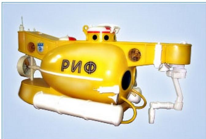
Корабельные комплексы для выполнения различных подводно-технических работ, используются в зависимости от предполагаемой глубины. Обитаемый подводный аппарат «Риф» используется для проведения подводно-технических работ на небольшой глубине, до 100 метров.
