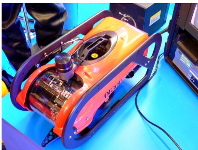
Миниатюрный телеуправляемый подводный аппарат (ТПА) «Обзор-150» представляет собой новое поколение подводных аппаратов, сочетающих в себе небольшие габариты и вес с широкими функциональными возможностями.
