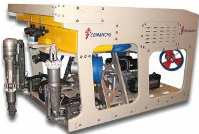
Фирмой Shilling Sub-Atlantic Aliance производится телеуправляемый подводный аппарат, или сокращенно ТПА, относящийся к легкому рабочему классу Comanche, который предназначается для установки на него двух манипуляторов, благодаря чему он становится идеальным для работ по обслуживанию буровых установок или иных гидросооружений, а также для проведения исследовательских работ.
